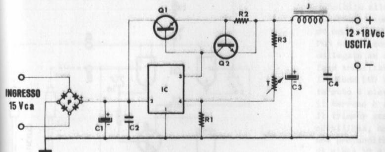
Questo alimentatore è stato realizzato per ottenere una tensione compresa tra 12 e 18 V regolabile con un trimmer.
